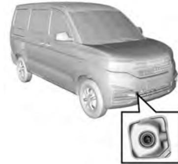
Hay una cubierta de orificio en el lado derecho de la defensa delantera del vehículo. Ábrala para tener acceso al orificio de fijación para la instalación del gancho.
