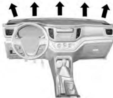
El aire pasa a través de las salida de aire del parabrisas y del descongelador del parabrisas de la puerta delantera.
