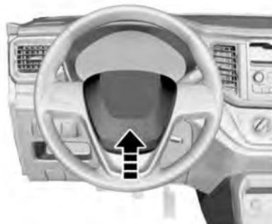
Presione la parte central del volante para sonar el claxon.
