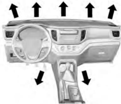
Este modo permite que el aire pase a través de la salida de aire del descongelador del parabrisas delantero, la salida de aire del descongelador de la puerta delantera, y la salida de aire del piso.
