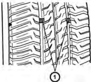
La llanta se debe reemplazar cuando aparezca el indicador de desgaste de la banda de rodamiento (1). Cuando la profundidad de la banda de rodamiento es igual o inferior a 1.6 mm debido al desgaste, el indicador de desgaste de la banda de rodamiento aparecerá entre las ranuras de la banda de rodamiento.
