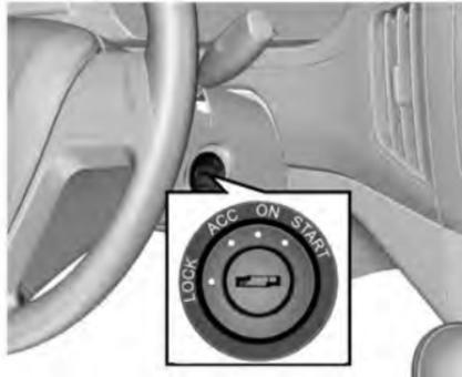
Cuando se gira la ignición en el lado derecho de la columna de dirección, las posiciones de operación son las siguientes:
