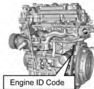
Está en el bloque del cilindro del motor cerca del volante de inercia.
