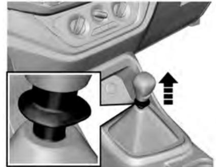
Cuando cambie la transmisión con seis velocidades de transmisión a R (Reversa), levante el anillo de bloqueo de la reversa primero y luego gire la palanca de cambios de Neutral a R (Reversa).
