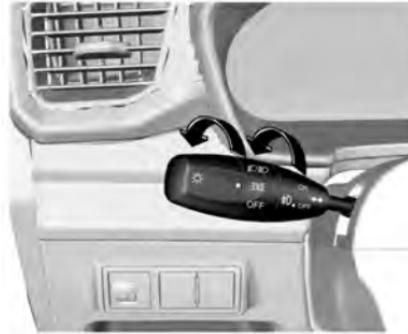
Cuando la ignición se coloca en ON y el faro funciona como una lámpara de posición o en luces bajas, gire el botón de anillo en el centro del interruptor de combinación a ON (conectado) para encender la luz antiniebla delantera.
