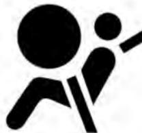
En el tablero de instrumentos, hay un indicador de bolsa de aire que muestra el símbolo de la bolsa de aire. El sistema verificará si el sistema de circuito de la bolsa de aire tiene una falla y el indicador le dirá si hay un problema. Consulte *Luz de disponibilidad de bolsa de aire* ⇨ 49.
