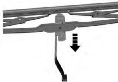
Ajuste la hoja del limpiador en un ángulo perpendicular al brazo del limpiador, y presione la hoja en la dirección de la flecha como se muestra en la figura para separar la hoja del brazo del limpiador.
