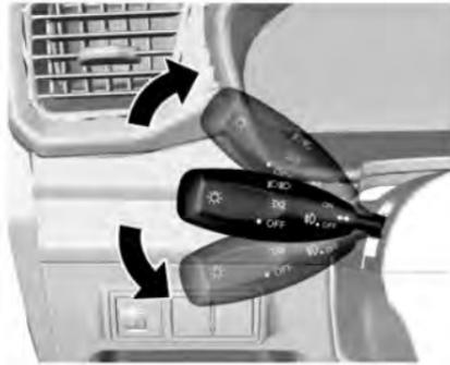
Para encender la luz indicadora de cambio de carril y la direccional, la ignición debe estar en ON.
