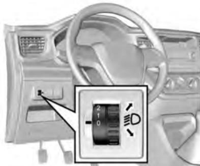
La perilla de nivelación del faro está en el lado izquierdo del tablero de instrumentos.
