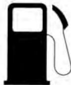
La luz de advertencia de combustible bajo se encenderá inmediatamente cuando se encienda la ignición. Indica que el sistema está realizando una inspección automática y que la luz de advertencia está funcionando normalmente.
