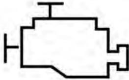
La luz indicadora se ilumina cuando la ignición está encendida pero el motor no ha arrancado. Esto indica que el foco de la luz del indicador está funcionando normalmente.
