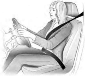
El cinturón de seguridad está diseñado para uso por un solo pasajero. Debido a las restricciones del cinturón de seguridad, un pasajero menor de 12 años o de menos de 150 cm de altura no debe sentarse en el
