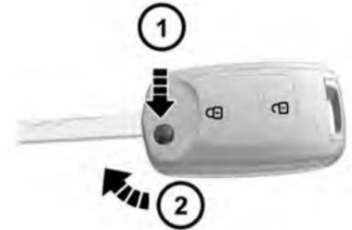
Las funciones del transmisor de entrada remota sin llave (RKE) pueden funcionar hasta 15 m de distancia del vehículo.
