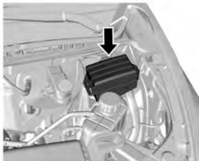
La caja de fusibles del compartimiento del motor está junto a la batería.
