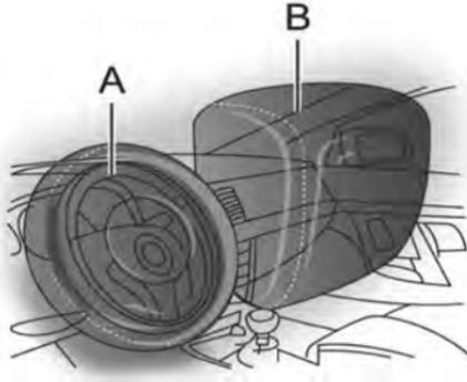
Como se muestra en la Figura A anterior, la bolsa de aire delantera del conductor está ubicada en el centro del volante.
