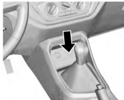
La caja de almacenamiento está debajo del tablero de control del aire acondicionado.
