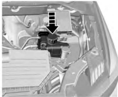
Cuando el motor está en un estado frío, el nivel de refrigerante debe estar entre MIN (mínimo) y MAX (máximo) marcado en el tanque de refrigerante. El nivel de refrigerante aumenta conforme la temperatura del motor aumenta y disminuye conforme el motor se enfría.
