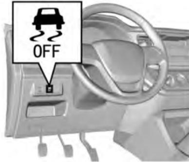
Presione el interruptor ESC OFF, y la luz ESC OFF en el grupo de instrumentos se ilumina, y algunas funciones ESC se desactivan. Presione nuevamente el interruptor ESC, la función ESC se activa nuevamente y la luz ESC OFF en el grupo de instrumentos se apaga.
