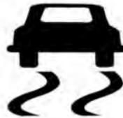
La luz de advertencia se ilumina después que se enciende la ignición y se apaga varios segundos después. Esto indica que la luz de advertencia está funcionando normalmente.
