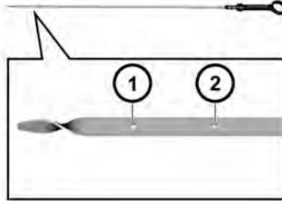
7. Observe el nivel de aceite en la varilla de medición de aceite. El nivel de aceite debe estar entre el límite inferior (1) y el límite superior (2).
