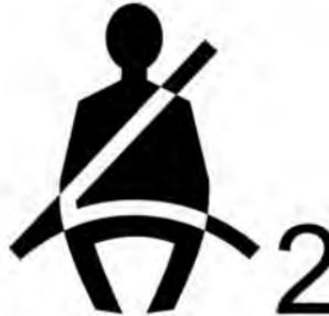
La luz de advertencia del cinturón de seguridad se ilumina si el asiento del pasajero delantero está ocupado pero el ocupante no se abrocha el cinturón de seguridad correctamente después de encender la ignición.
