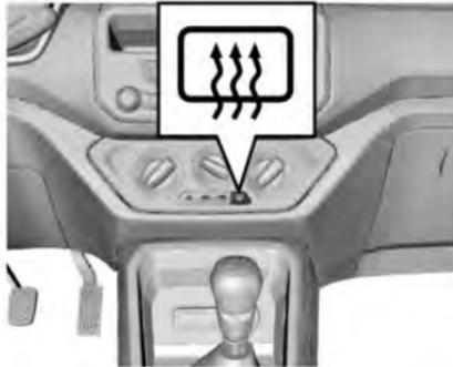
Para descongelar la ventana trasera, encienda la ignición y presione el botón del descongelador de la ventana trasera. El indicador debajo del botón se ilumina. Presione de nuevo para apagar el descongelador.
