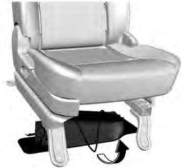
El gato, juego de herramientas y triángulo de advertencia están colocados debajo del asiento del pasajero delantero. Mueva el respaldo del asiento del pasajero delantero y afloje la banda de fijación debajo del frente del asiento para retirar el juego de herramientas.
