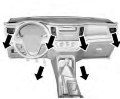
En este modo, el aire fluye en dos direcciones. La mitad del aire sale de la salida de aire de piso; el aire restante sale de la salida de aire central y la salida de aire lateral.
