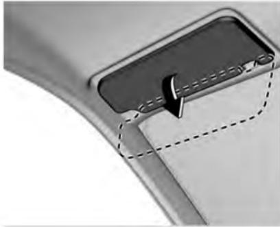
Su vehículo está configurado con una visera que puede reducir el brillo en los asientos delanteros del lado del conductor y del pasajero.
