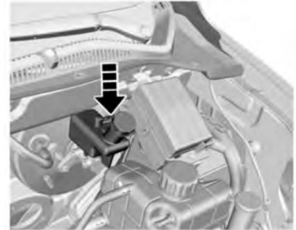
Antes de abrir la tapa de relleno, limpie el área alrededor de la tapa de relleno del depósito de líquido de frenos/embrague.
