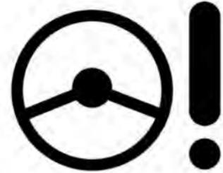
La luz de advertencia de dirección asistida se encenderá inmediatamente cuando se encienda la ignición. Indica que el sistema está realizando una inspección automática y que el foco de la luz de advertencia está funcionando normalmente. La luz de advertencia se apaga varios segundos después.
