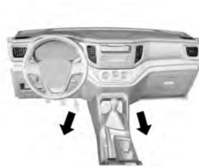
La mayor parte del aire sale de la salida de aire del piso; sale poco aire del parabrisas, y la salida de aire del desempañador de la ventana delantera y la salida de aire lateral.
