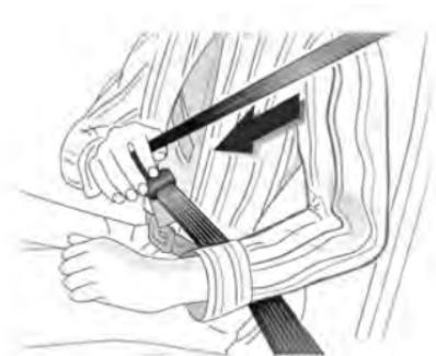
1. Extraiga el cinturón de seguridad del enrollador y ajústelo a través del cuerpo sin torcerlo.
