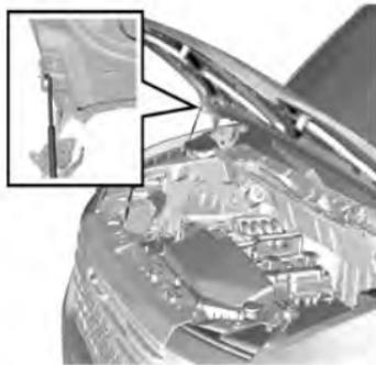
3. Separe la varilla de soporte del cofre de la abrazadera de fijación. Conecte el extremo libre de la varilla de soporte en la ranura.
