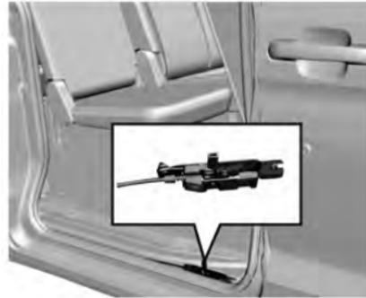
El mecanismo de bloqueo se proporciona junto al riel inferior de la puerta central derecha.
