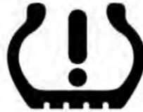
La luz de advertencia de presión de llanta se ilumina después de encender el interruptor de ignición y se apaga varios segundos después. Esto indica que la luz de advertencia está funcionando normalmente.
