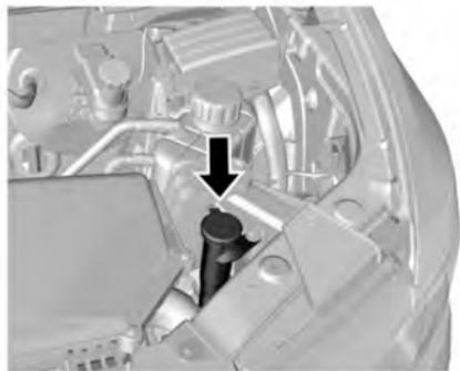
Antes de conducir, asegúrese que el depósito de fluido contenga suficiente solvente de lavado especificado.
