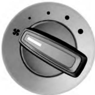
Gire la perilla de control de velocidad del ventilador para controlar el flujo de aire del sistema.
