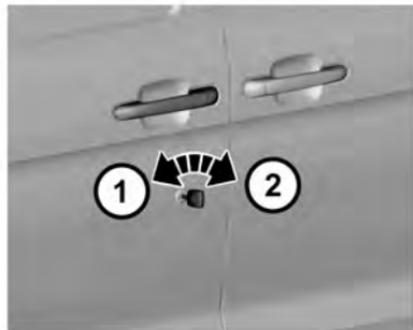
Para bloquear una puerta desde el exterior con una llave, inserte la llave y gírela en sentido contrario a las manecillas del reloj (1). Gire la llave en sentido de las manecillas del reloj para desbloquear la puerta (2).
