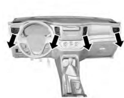
En este modo, el aire sale de la salida de aire central y la salida de aire lateral.
